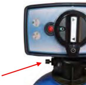
Fermer la vis du mitigeur et soutirer suffisamment d'eau par un robinet à proximité pour que l'installation se vidange de l'eau non traitée afin de procéder à une analyse TH. L'eau doit être totalement adoucie (0 à 2 °TH).
